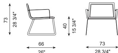
Estructura interna de metal recubierta de poliuretano inyectado. Estructura de las patas y laterales en acero inoxidable o hierro pintado.
